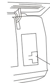
Кнопка вкл./выкл. автоматического режима
