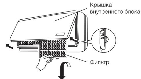
1. Поднимите крышку лицевой панели двумя руками в направлении на себя и вверх.
